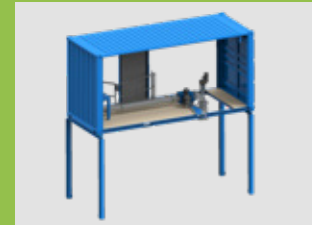
NUDELMAKER Schlammgranulation in Aufsatzcontainer integriert
